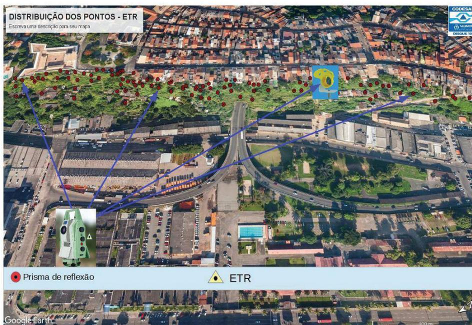
Imagem2 - Representação da distribuição dos prismas e aferição de posicionamento pela ETR
